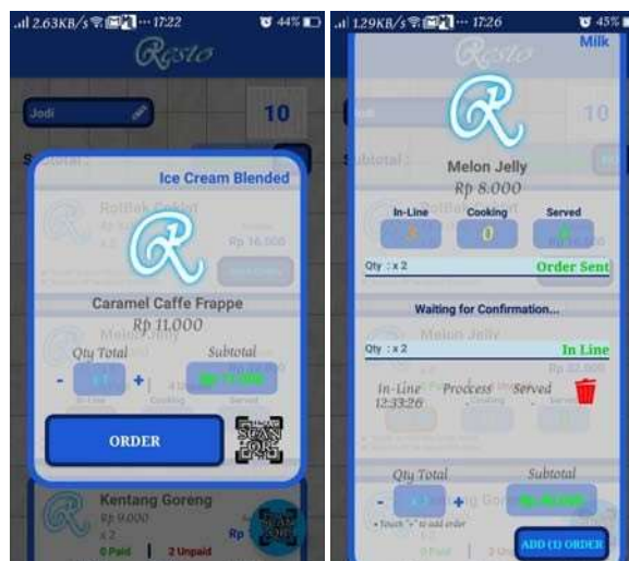
Gambar 4.18 Dialog Menu Info saat menu belum ada pada daftar pesanan (kiri) dan saat menu sudah ada pada daftar pesanan (kanan)
